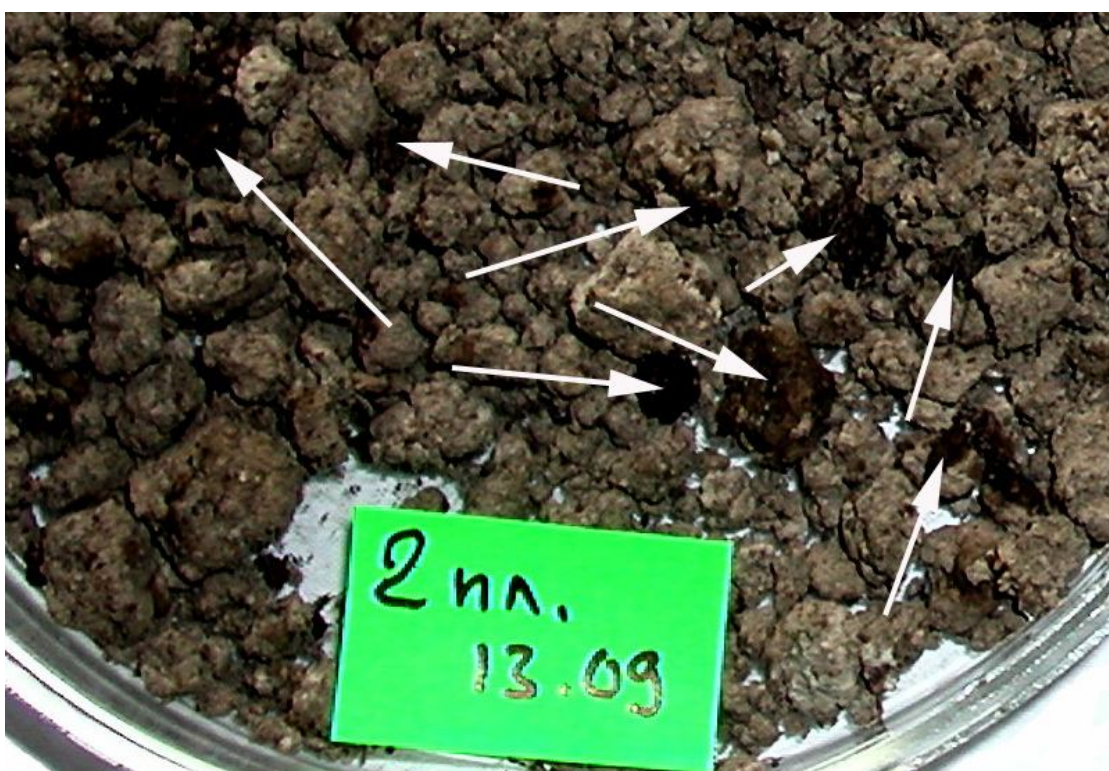
Рис. 6. Агломераты углеводородов в грунте из площадки 2.
