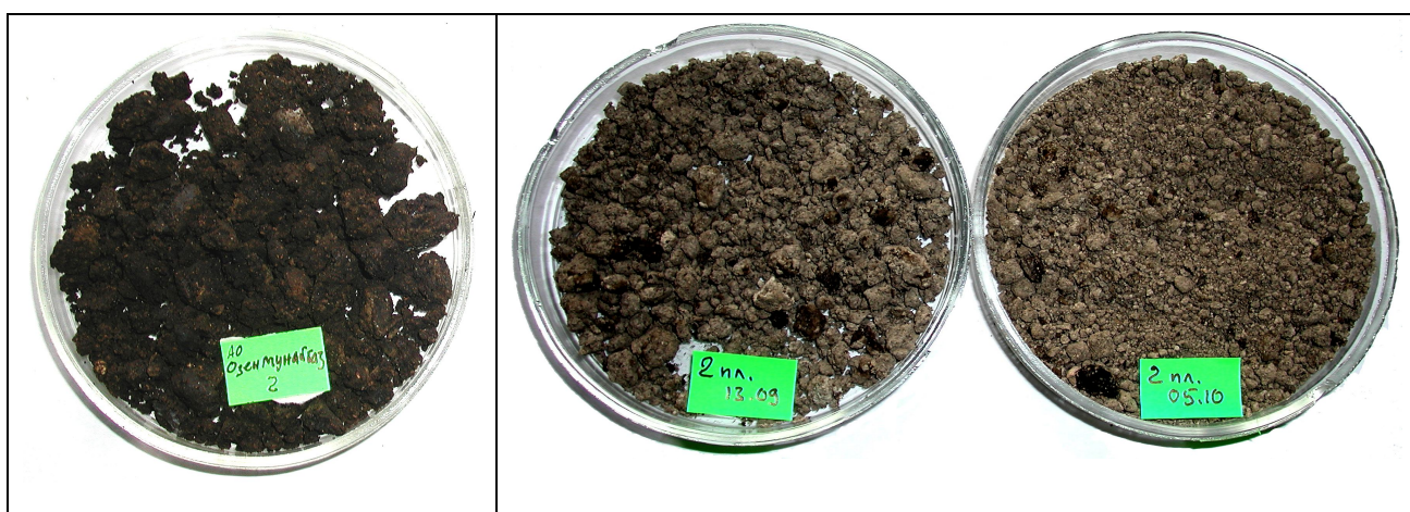
Рис. 2 Фотографии образцов грунта, отобранных на площадке №1; справа – начальный образец, далее пробы от 13.09 и 05.10. 2012 г.
